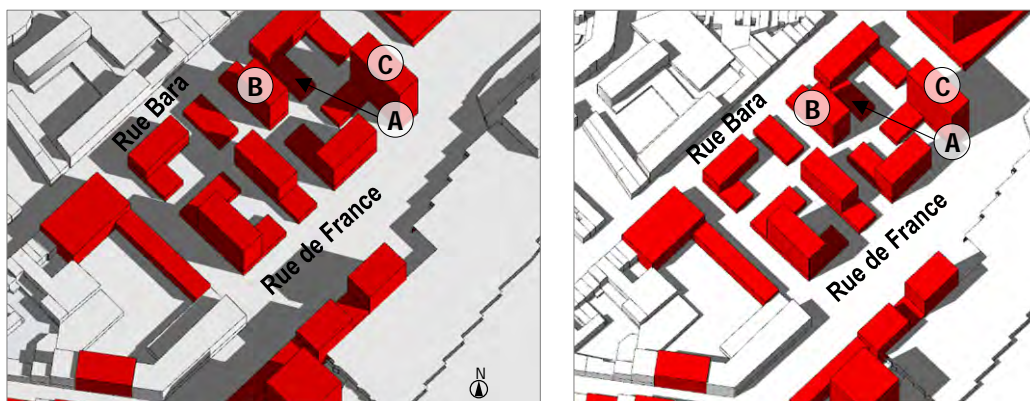
Figure 400 : Ombres portées du projet de PAD sur les bâtiments projetés en été à 10h (à gauche) et à 16h (à droite) en variante 1 (ARIES, 2019)
