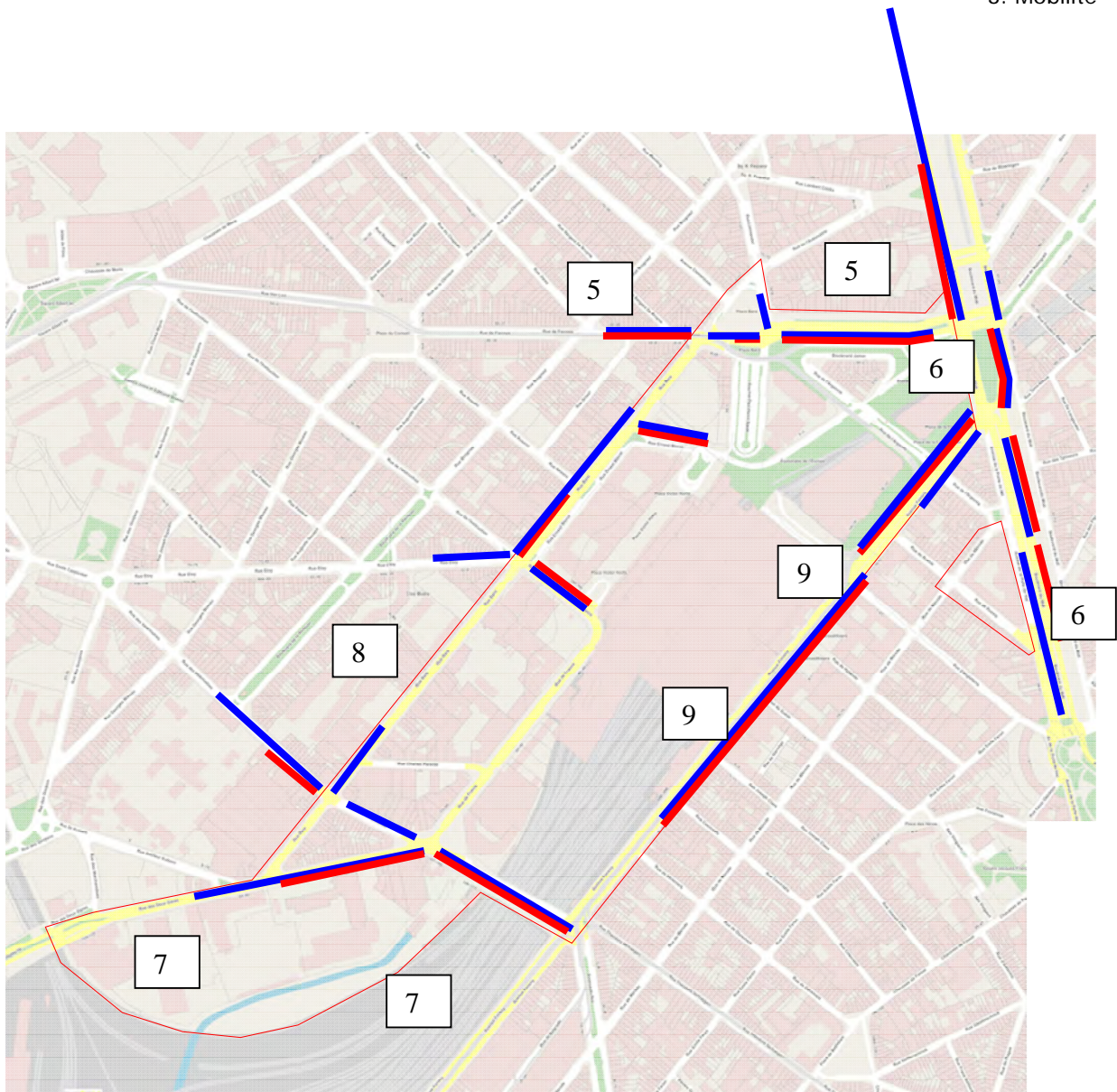
Figure 138: Remontées de files en heures de pointe du matin (bleu) et en heures de pointe du soir (rouge) pour le périmètre d'étude (ARIES, 2018)
