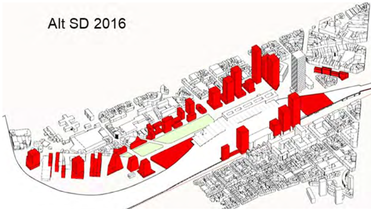
Figure 517 : Vue globale de l'alternative SD 2016. Les volumes coloriés en rouge représentent les nouveaux volumes par rapport à la situation actuelle. Si seule la façade est coloriée, il s'agit, dans le projet, du maintien du bâtiment mais de son réaménagement intérieur. La plage verte représente un parc.
