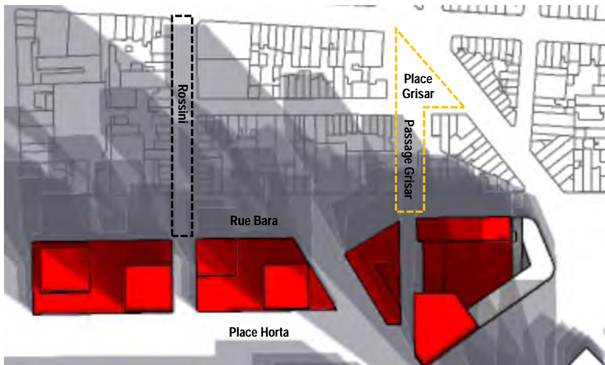
Figure 379 : Extrait de la carte du cumul des ombres du projet de PAD en été de 8h à 12h (ARIES, 2019)
