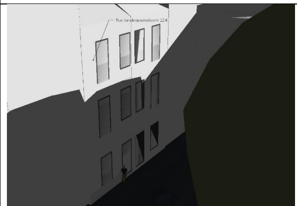
Figure 246 : Simulation des ombres portées sur la rue Vandepereboom en situation projetée le 20/03 à 16h40 (Source : ABO)
