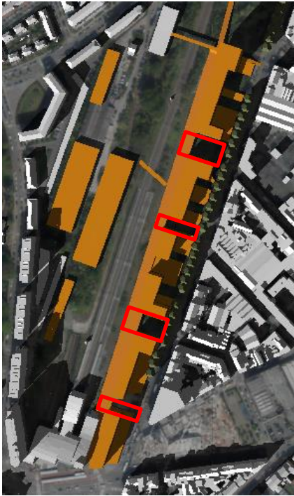
Figure 229 : Simulation des ombres portées sur le quadrant quartier en situation projetée le 22/09 à 15h00 (Source : ABO)
