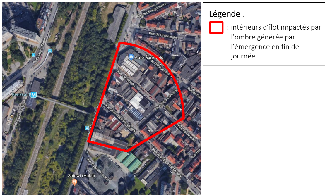
Figure 293 : Intérieurs d'îlot impactés par l'ombre générée par l'émergence en fin de journée
