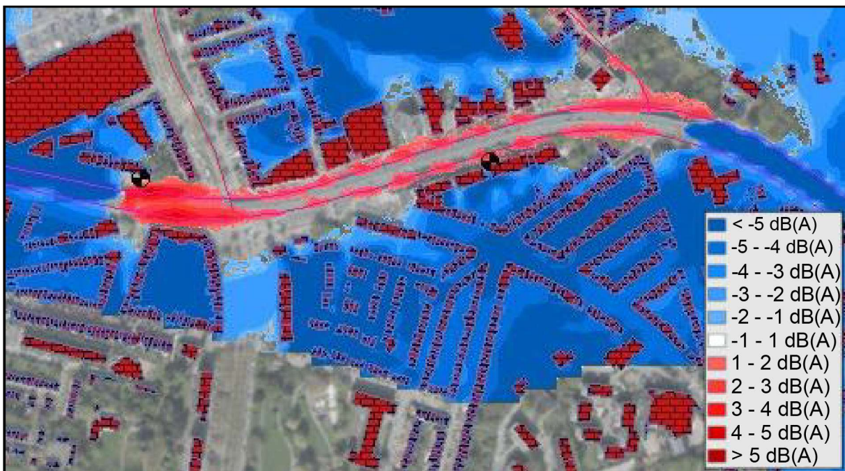
Afbeelding 890: Impact van het wegvallen van het Herrmann-Debrouxviaduct - Verschil tussen het preferentiële en het trendscenario (Antea, 2018)
