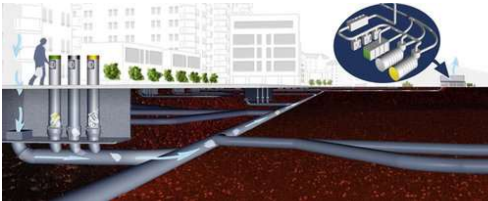
Afbeelding 73: Ondergronds schema van een geautomatiseerd pneumatisch inzamelsysteem. Bron: International Tunneling and Underground Space Association, 2015
