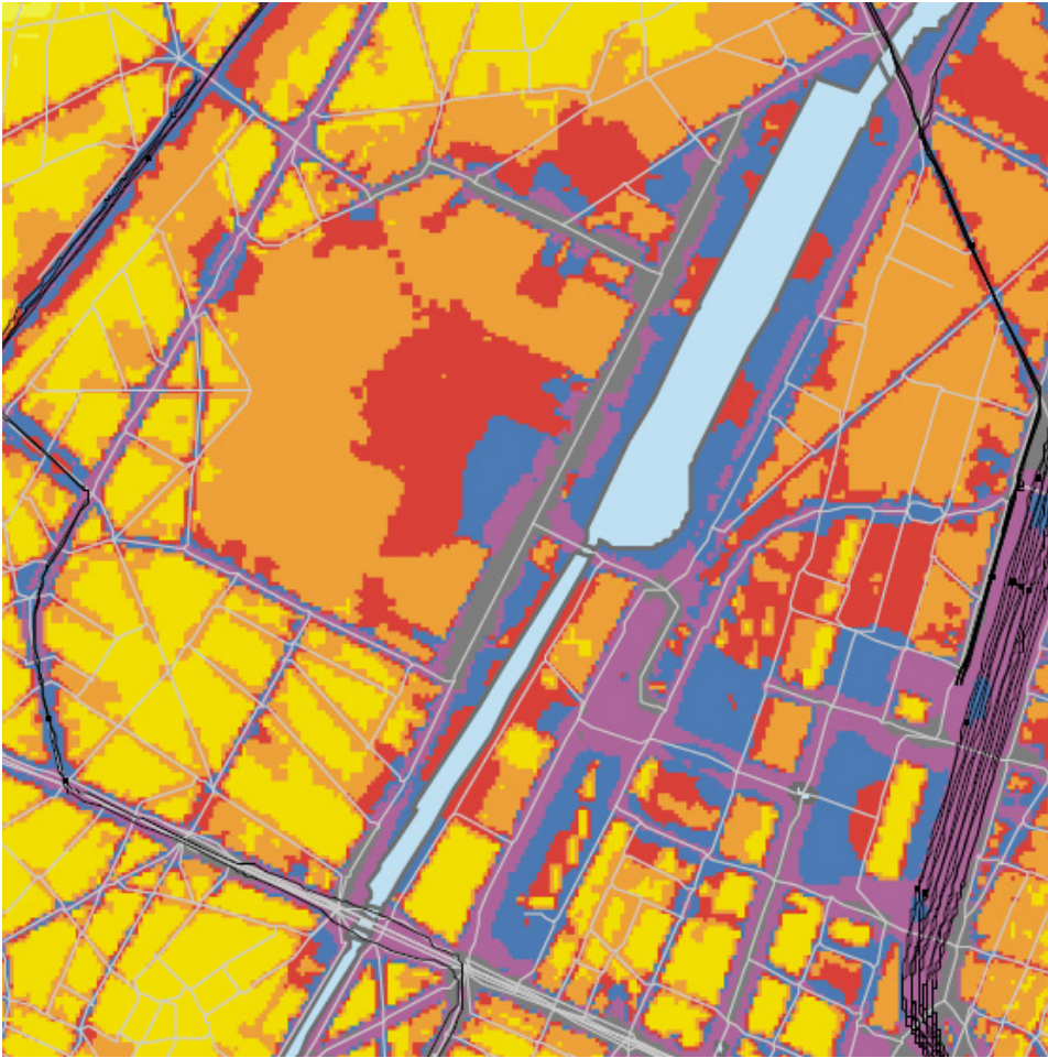
Cadastre du bruit des transports terrestres de la Région de Bruxelles-Capitale. Carte de multi-exposition. Année 2006 - Indicateur global Lden (jour, soir, nuit) / Overzicht van geluidsniveau van wegen transport in het Brussel's hoofdstedelijk gewest. Kaart van de veelvoudige blootstelling. Jaar 2006 - algemene indicators Lden (dag, avond, nacht)
