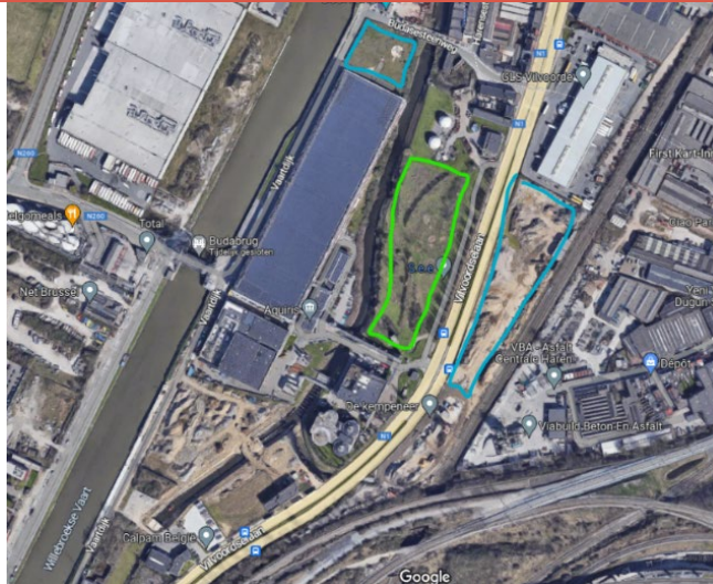
FIGUUR 37: LUCHTFOTO MET DE ZONE VOOR DE GEPLANDE BIOMETHANISATIE-EENHEID (GROEN) EN DE POTENTIËLE SITES VOOR DE UITBREIDING VAN HET WATERZUIVERINGSSTATION
