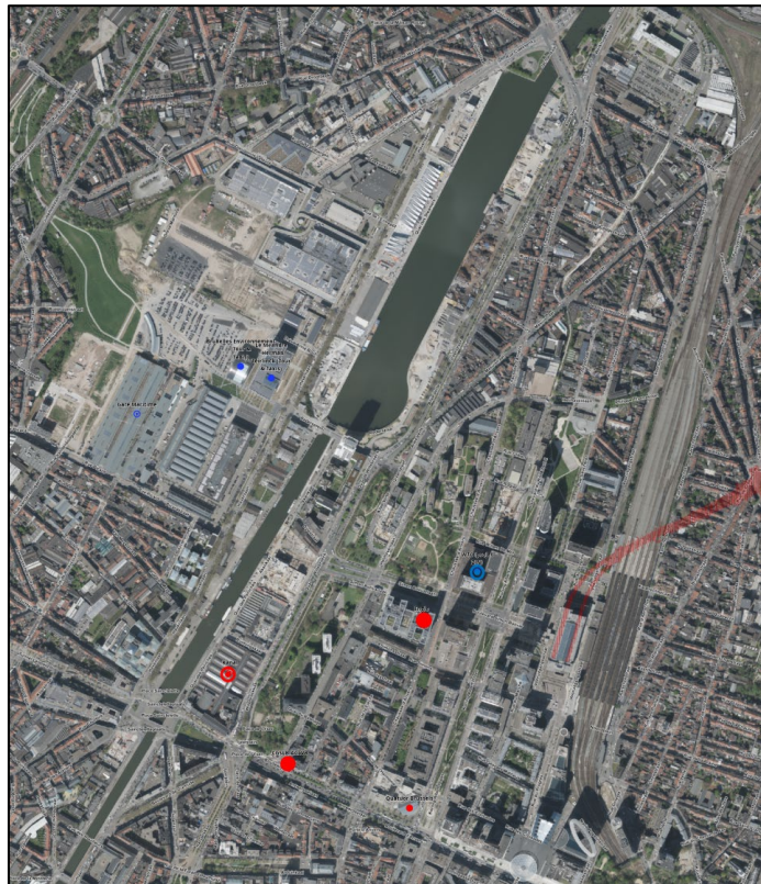
Figuur 168: Open (rood) en gesloten (blauw) geothermische exploitatiesystemen binnen de OP (bron: Leefmilieu Brussel)
