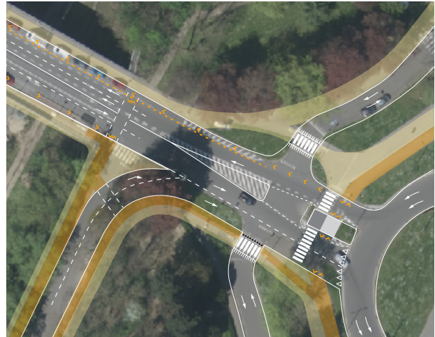
Figuur 32: Schema van de toegang tot de rotonde op de Leopold III-laan
