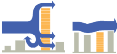
Figur 77: Invloed van verschillende hoogten, of net uniformiteit van hoogte, op de windstromen (Bron: UCL/CLI (juni 2009). BXXL – "Objectivation des avantages et inconvénients des immeubles élevés à Bruxelles")
