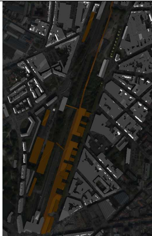
Figuur 194 : Simulatie van de schaduw in de geplande toestand op 21/12 om 16u00 (Bron : ABO)
