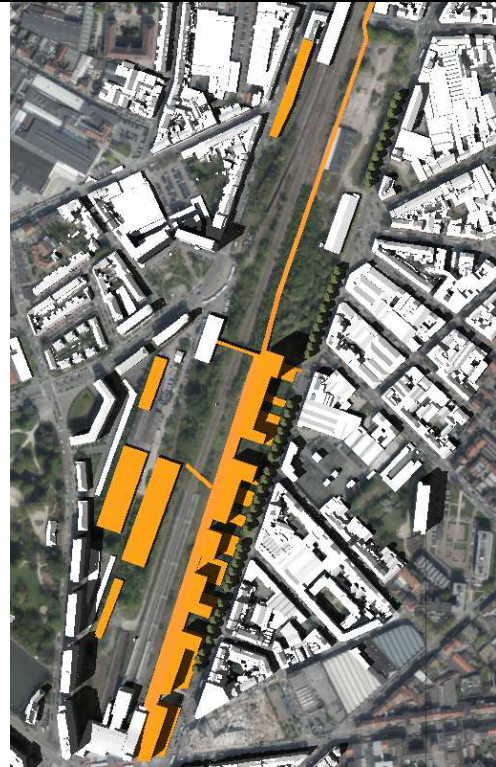
Figuur 176 : Simulatie van de schaduw in de geplande toestand op 21/06 om 15u00 (Bron : ABO)
