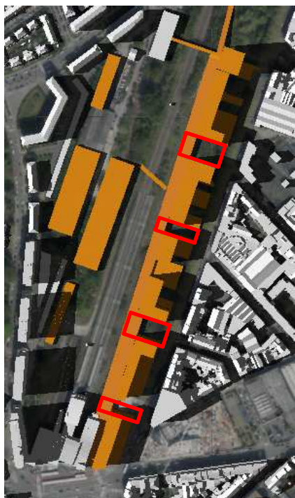
Figuur 227 : Simulatie van de schaduw op het kwadrant wijk in de geplande toestand op 21/06 om 17u00 (Bron : ABO)
