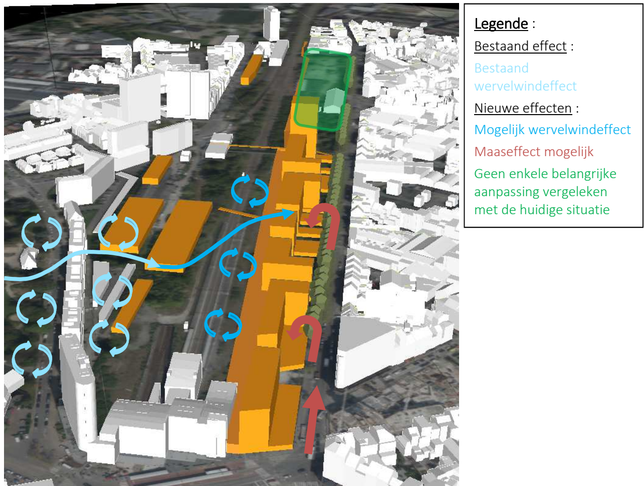
Figuur 162 : Te verwachten effecten van de afstroming van de wind in de geplande toestand
