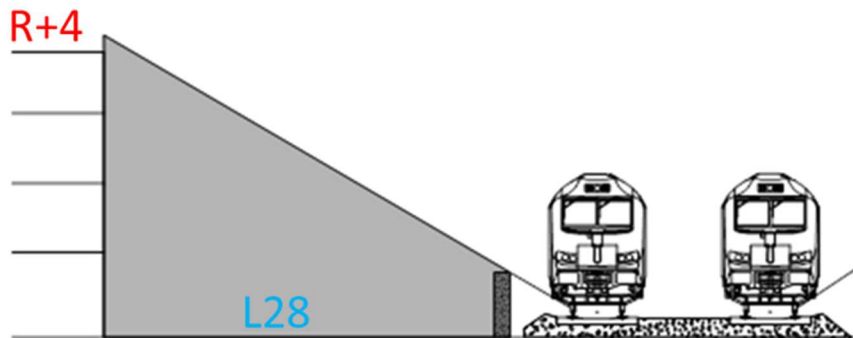
Figuur 156: Verspreiding van geluid van de opslagsporen van de MIVB met plaatsing van schermen (Tractebel)
