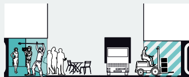
SCHEMA 1 – Activiteitensteegje: "functionele uitbreiding" (minimale breedte van een steegje: 10 m)
